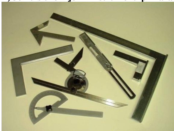
za mjerenje i kontrolu kuteva
